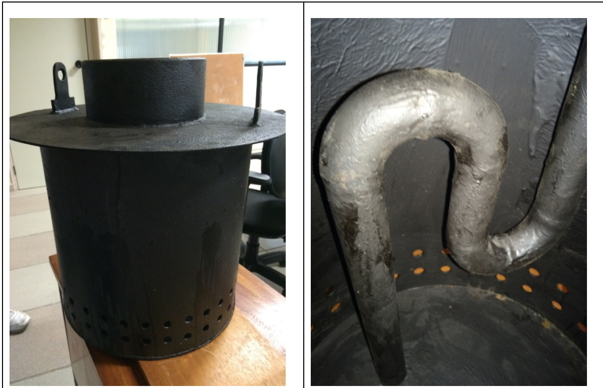
Figura 3: Fotografias da Coluna de Carvão Ativado (sem preenchimento), com destaque para o sifão de descarga da água pluvial.
